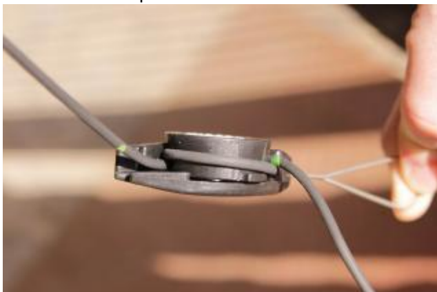
Sledovaná kotva po demontáži – detail
